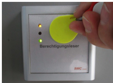
Karte oder Chip aktivieren (Ton und grüne LED)
