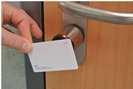
Rotleuchtende LED weist auf Fehler hin
